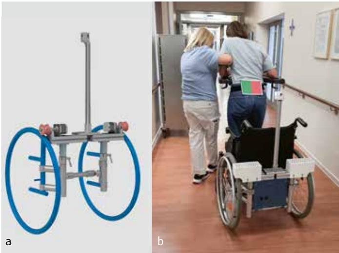
Abbildung 3: a) CAD-Entwurf des Aufbaus im vereinfachten Rollstuhlrahmen (blau) b) Anwendung in einer simulierten Therapiesituation.
