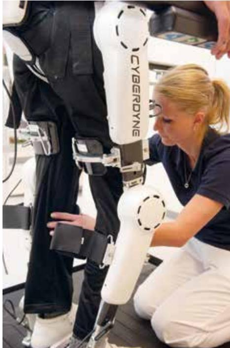
Abb. 4: Anlegen des Roboteranzugs.
