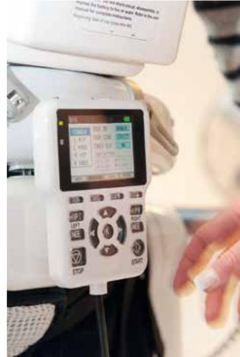
Abb. 5: Steuerungseinheit der Trainingsintensität.
